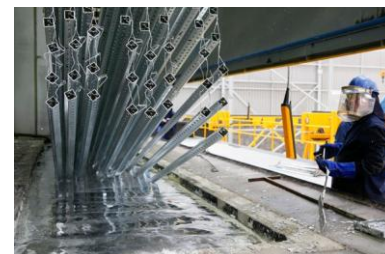
La galvanisation selon EN ISO 1461 est appliquée après la fabrication des composants en acier afin d'assurer une couverture complète du revêtement.
